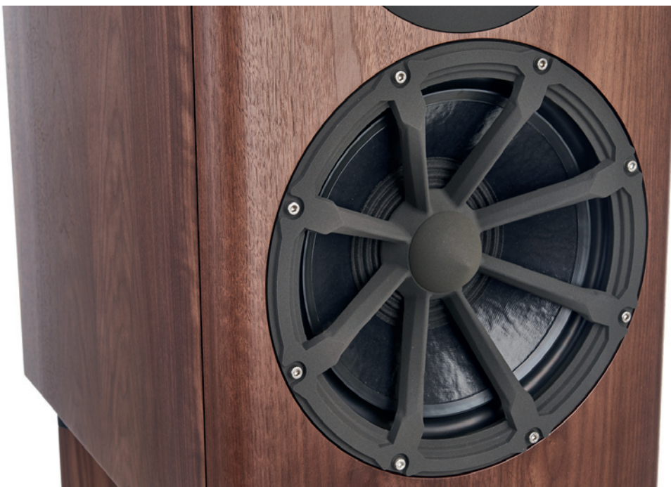
Das optisch ungewöhnliche Tiefton-Chassis der MB2se bezieht PMC von Volt Loudspeakers. Die Streben des Radialtreibers sind mit dem Polkern verbunden und dienen der Wärmeableitung der Schwingspule
