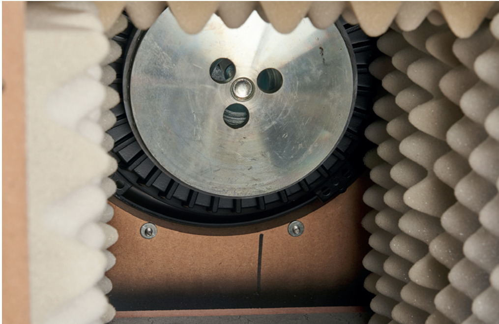
Von hinten betrachtet wirkt der Tieftöner weniger spektakulär. Die Transmission Line ist mit Noppenschaum ausgekleidet
