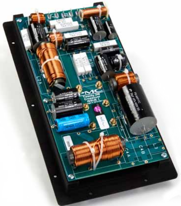
Es wird eine hochkomplexe und technisch durchdachte Frequenzweiche eingesetzt, um eine nahtlose Integration der Hoch-, Mitten- und Basstreiber der twenty.26 zu erreichen. Sie stellt die perfekte Bereitstellung der entsprechenden Frequenzanteile für jeden der drei Treiber sicher.
